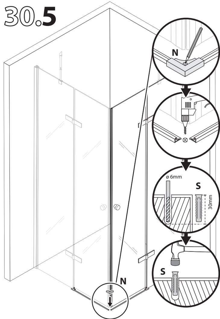
**DE** - Schieben Sie die Bodenleisten zusammen und legen die Eckverbindung (N) drüber. Bohren Sie die vorab markierte Stelle. Anschließend, schieben Sie den Dübel (S) hinein.
