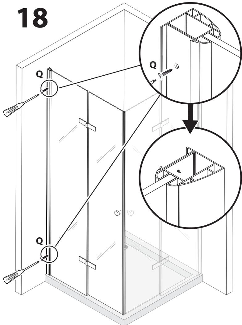
**DE** - Verschrauben Sie die Profile miteinander. Nutzen Sie dafür die beigefügten Schrauben (Q).
