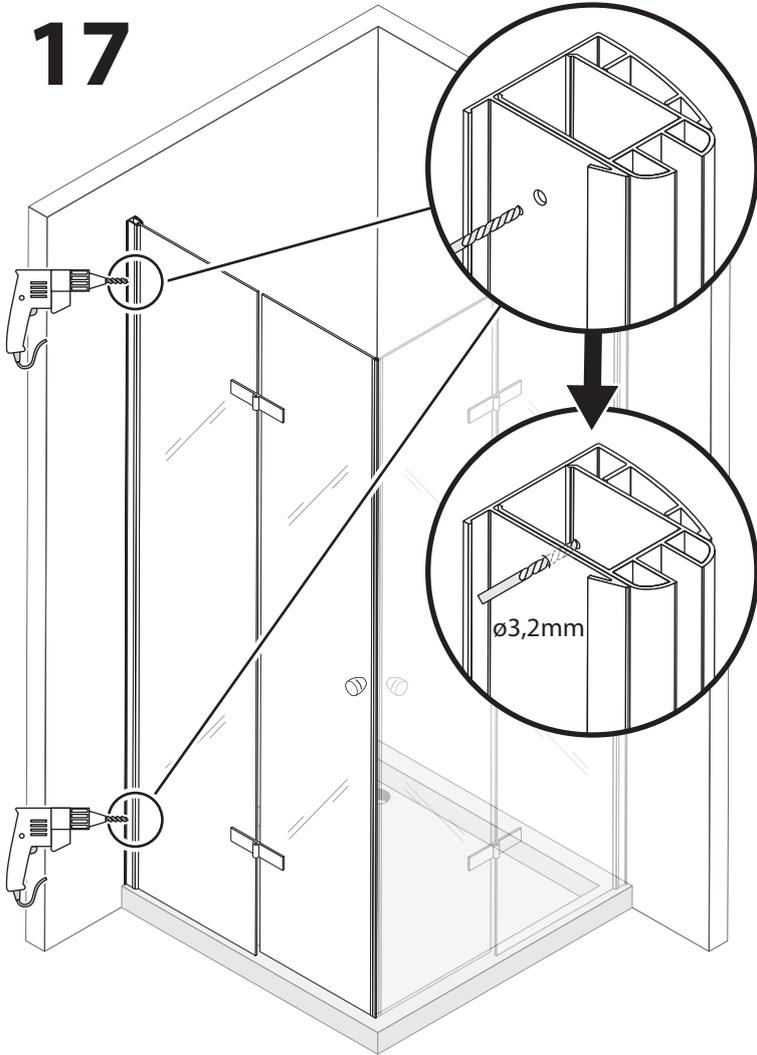
**DE** - Bohren Sie nach dem Ausrichten durch das Wandprofil und Innenprofil, an den vorgegebenen Stellen. Bohren Sie jedoch nicht zu tief, um die Außenseite des Profils nicht zu beschädigen.
