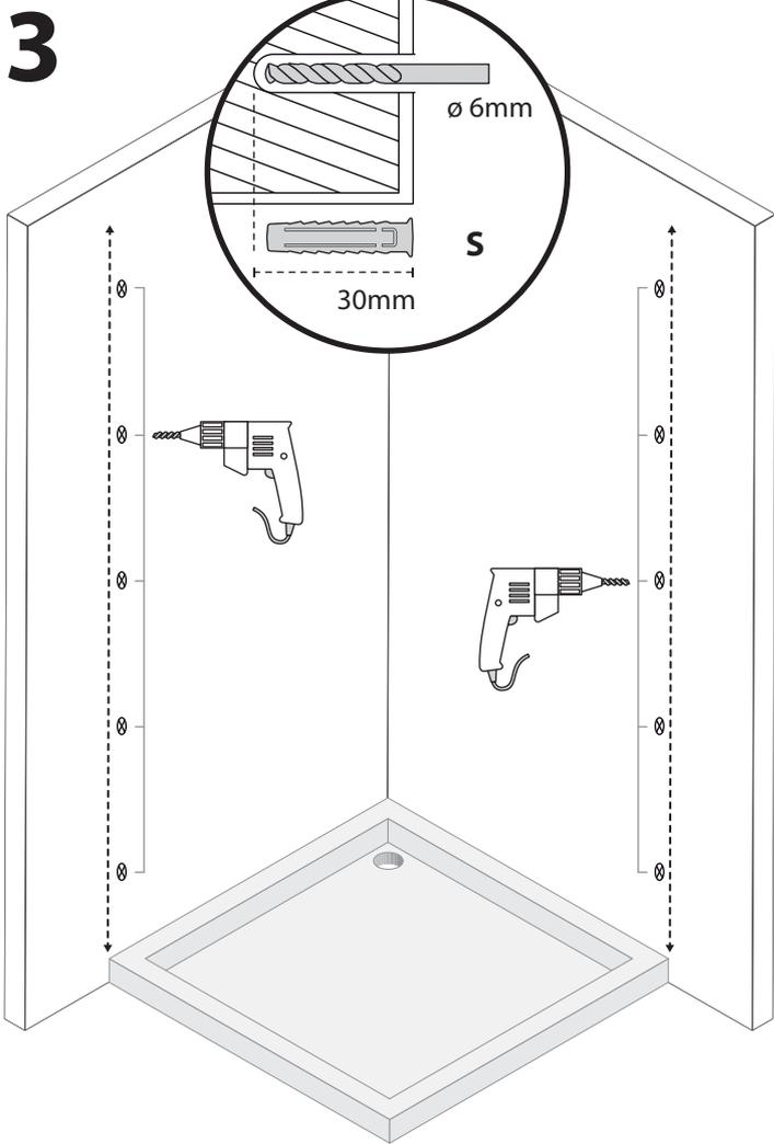
**DE** - Bohren Sie die vorab markierten Bohrpunkte, benutzen sie hierbei, wie auf der Zeichnung, den Bohraufsatz ( $\varnothing$ 6mm).
