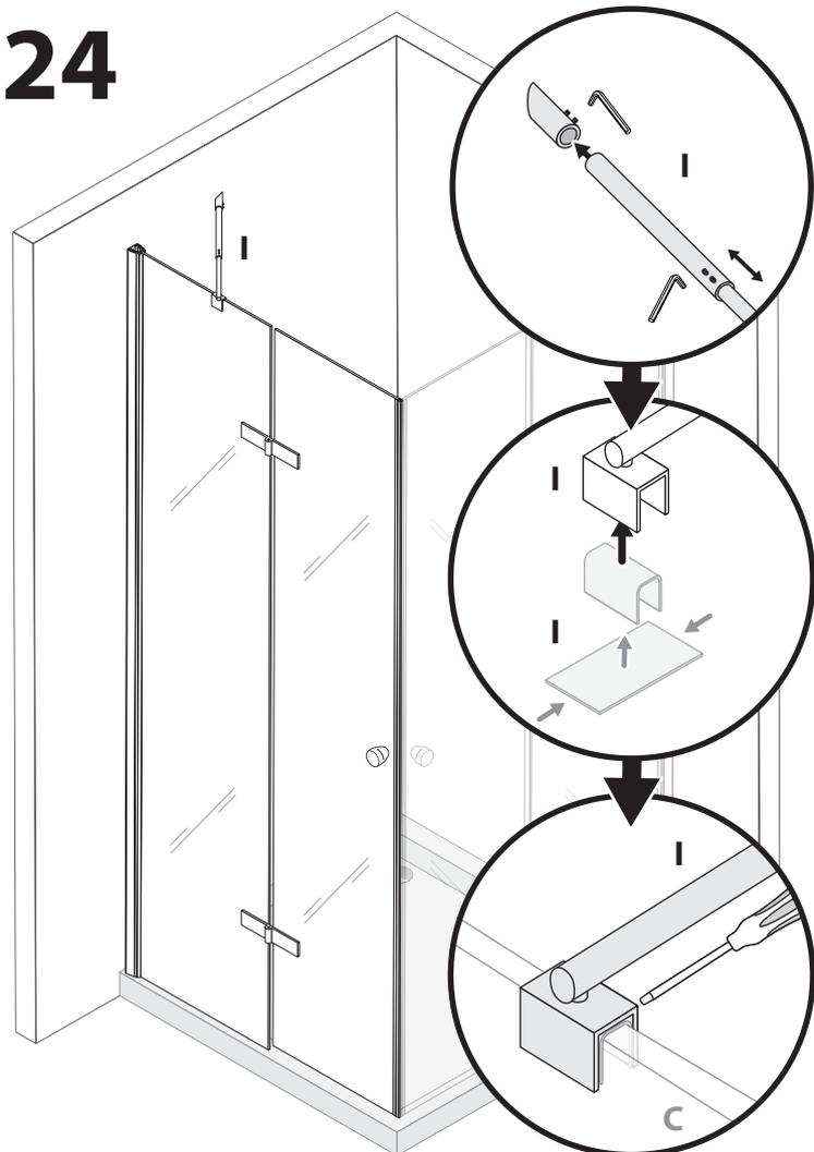
**DE** - Stellen Sie die ausziehbare Stange (I) nach Ihren Wünschen ein. Falten Sie den Schutzgummi in eine „U“-Form und platzieren Sie ihn in der gewünschten Position auf der Glasscheibe. Schieben Sie nun den Halter auf das Glas zwischen die Gummis.
