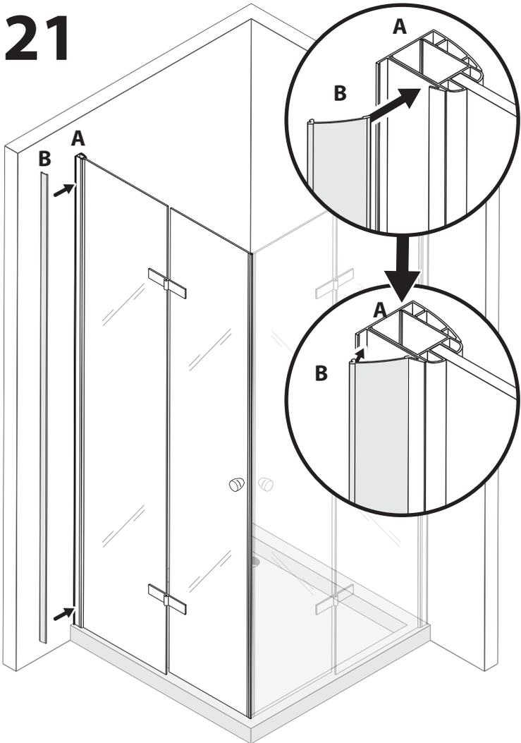
**DE-** Klipsen Sie nun die Alublende (B) in das Wandprofil (A), um die Verschraubungen zu verdecken.
