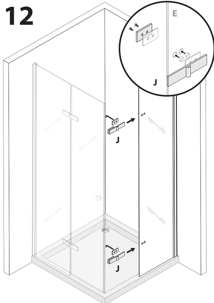
**DE** - Verschrauben Sie die Scharniere (J) an die hintere Scheibe (C), wie in der Detailzeichnung angezeigt ist.
