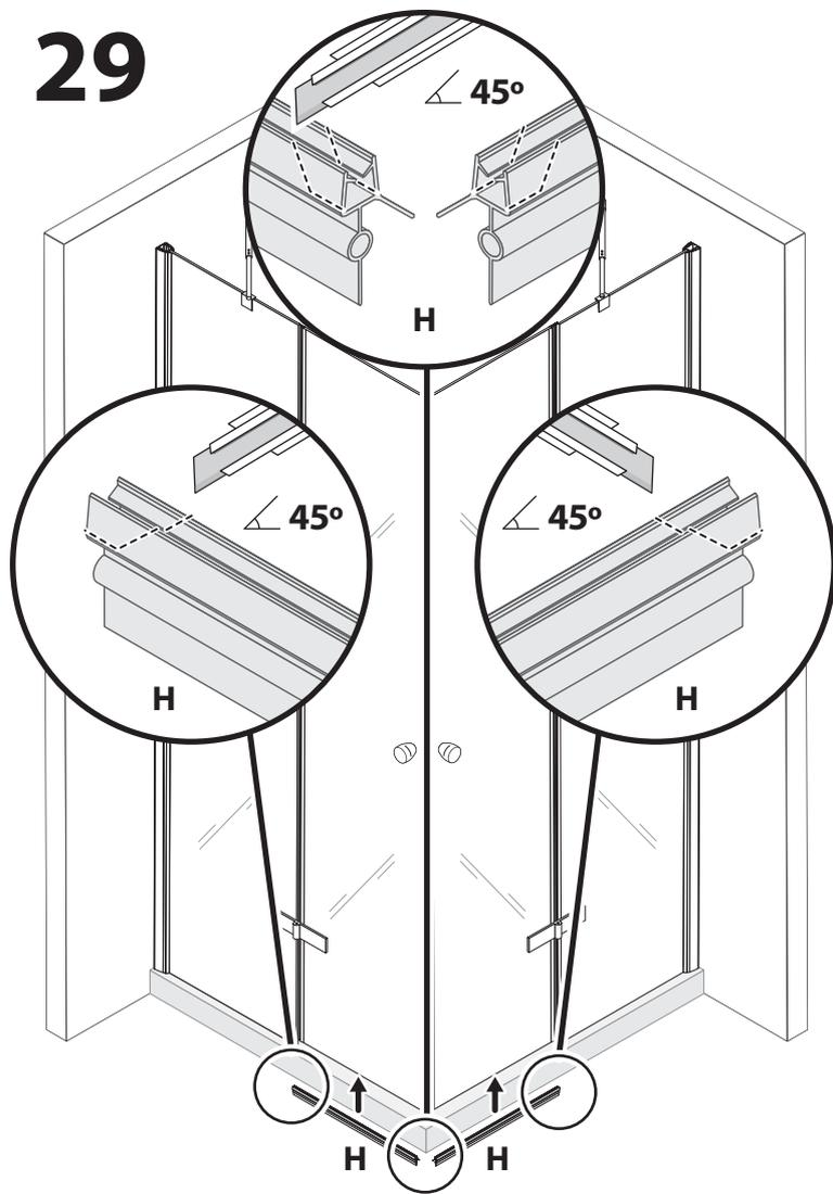
**DE** - Schneiden Sie die unteren Dichtungen (H), wie in der Zeichnung angegeben, im 45 Grad Winkel zurecht. Anschließend schieben Sie die unteren Dichtungen (H) auf die Türscheiben. Achten Sie darauf, dass die abstehende Lippe in den Duschbereich zeigt.
