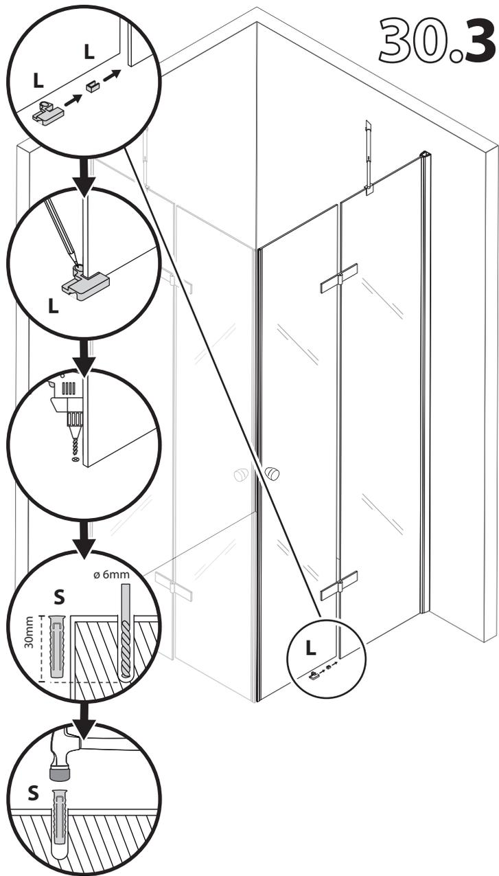
**DE** - Verbindungsstück (L) aufsetzen und Bohrstelle markieren. Verbindungsstück entfernen, in die Markierung bohren und Bodendübel (S) einsetzen.
