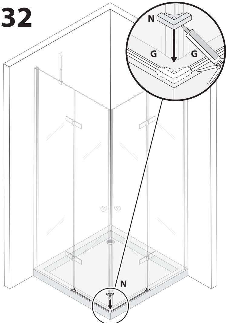
**DE** - Tragen Sie Silikon unter dem Verbinder (N) auf und platzieren Sie ihn über dem Bodenprofil (G), wodurch beide verbunden werden.
