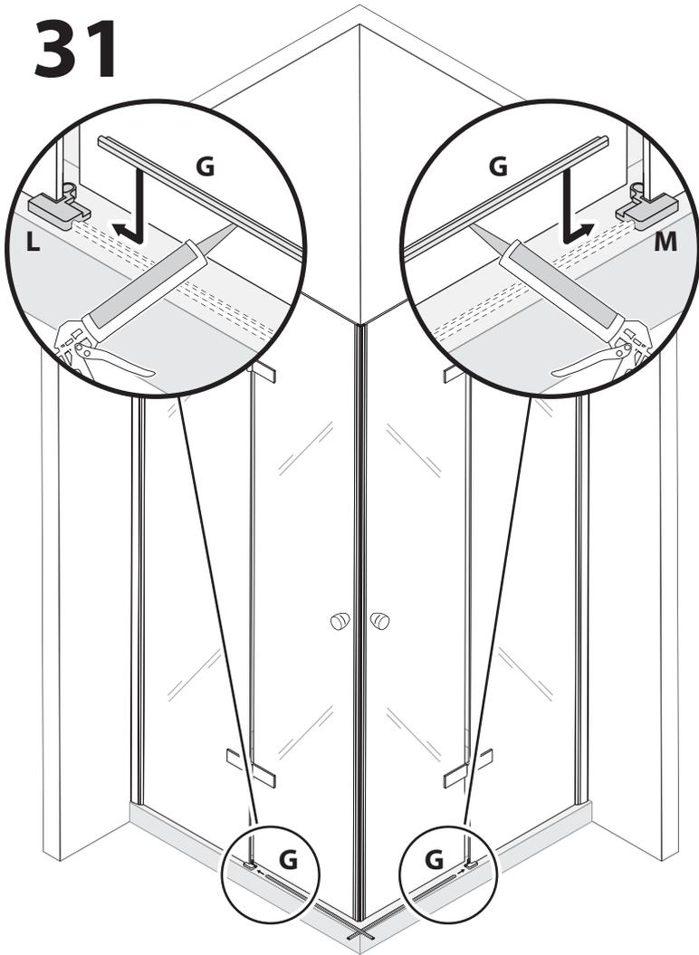
**DE** - Tragen Sie Silikon unter das Bodenprofil (G) auf und stecken Sie es in den Verbinder (L und M). Stellen Sie sicher, dass es mit den Glastüren ausgerichtet ist.
