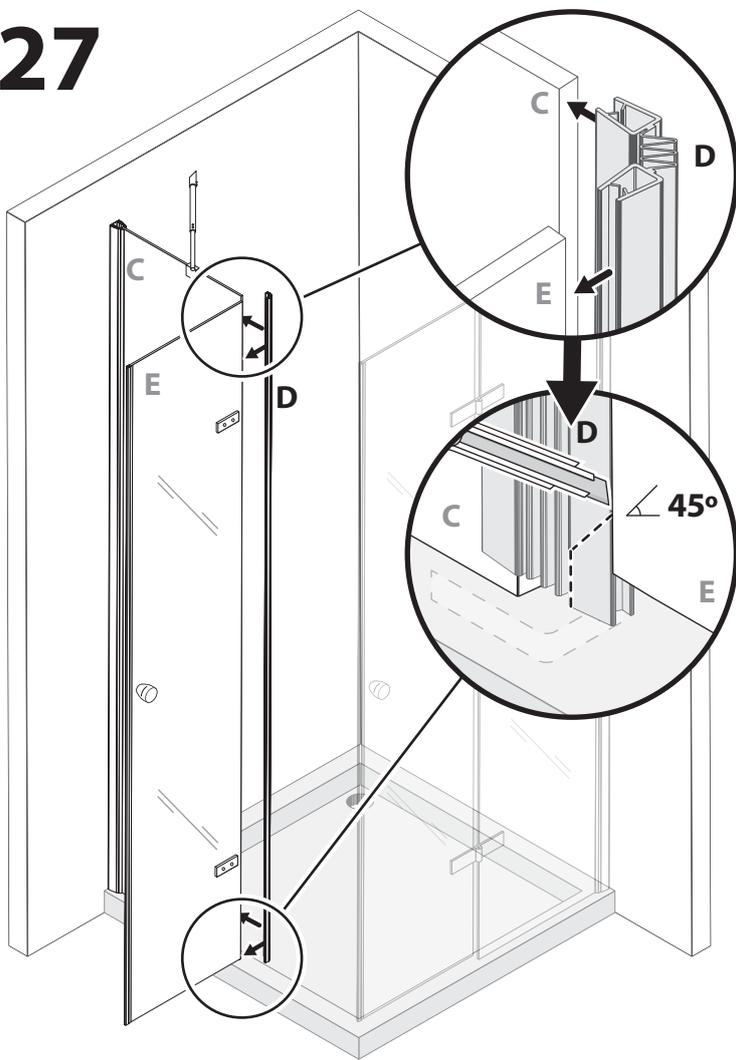
**DE** - Schneiden Sie die untere Faltdichtung (D), wie in der Zeichnung angegeben, im 45 Grad Winkel zurecht. Anschließend schieben Sie die Faltdichtung auf die Scheiben (C und E).
