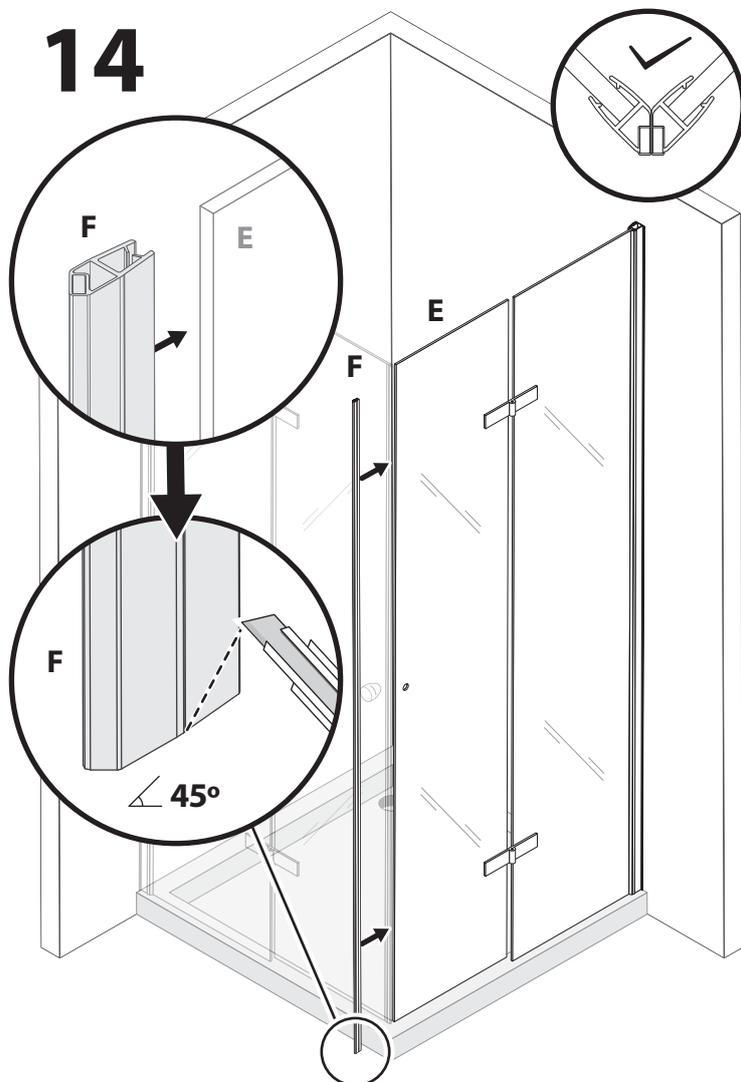
**DE** - Schneiden Sie die Magnetdichtung (F), wie in der Zeichnung angegeben, im 45 Grad Winkel zurecht. Anschließend schieben Sie die Magnetdichtung (F) auf die Türscheibe (E).
