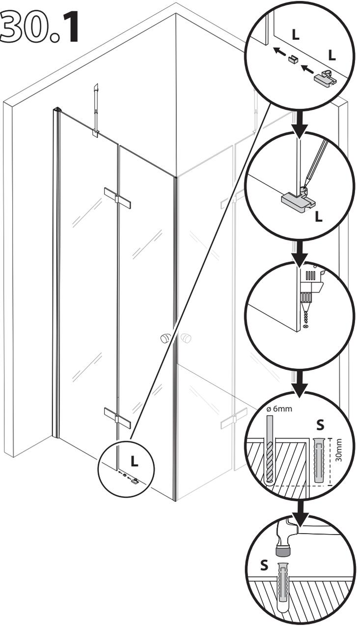
**DE - Optionale Montage:** Verbindungsstück (L) aufsetzen und Bohrstelle markieren. Verbindungsstück entfernen, in die Markierung bohren und Bodendübel (S) einsetzen.
