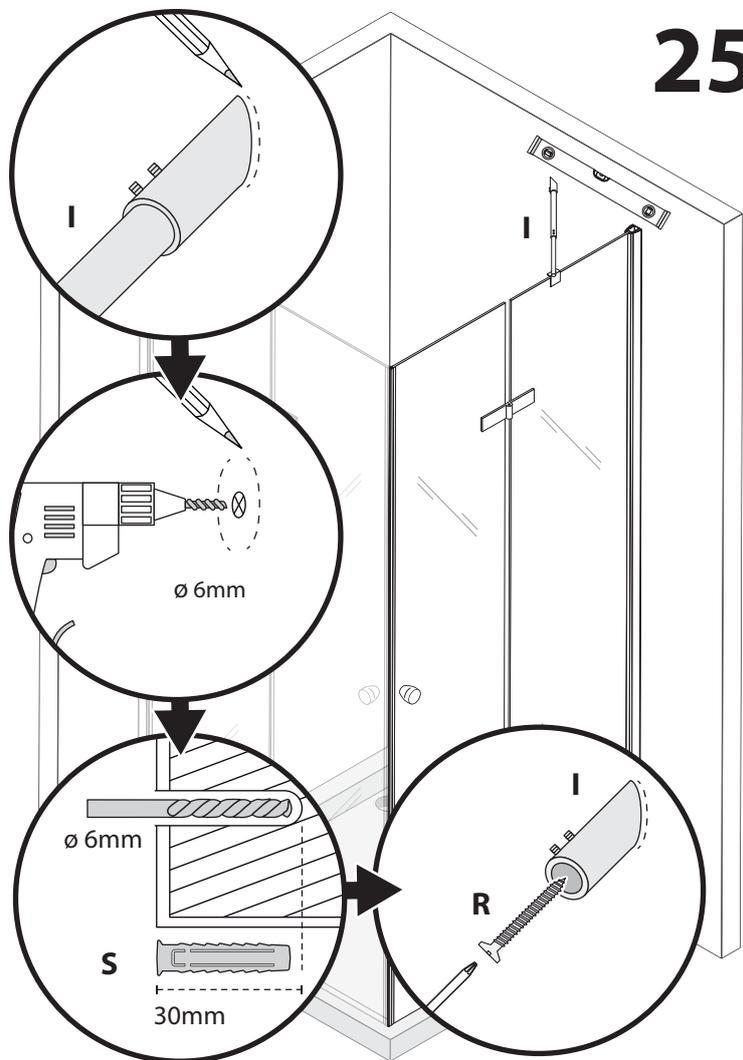
**DE** - Markieren Sie den Bohrpunkt für die Wandhalterung (I) der Haltestange. Bohren Sie anschließend den vorab markierten Bohrpunkt und schieben Sie den Dübel (S) hinein. Verschrauben Sie die Wandhalterung mit den beigefügten Schrauben (R).
