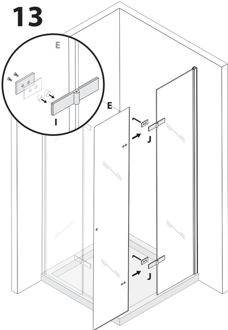
**DE** - Setzen Sie nun die Türscheibe (E) an die Scharniere (J) an und verschrauben Sie diese.
