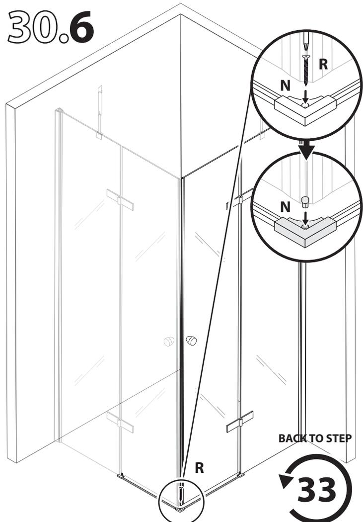
**DE** - Schrauben Sie den Eckverbinder (N) ein, verwenden Sie die mitgelieferte Schraube (R) und verschließen Sie den Verbinder.
