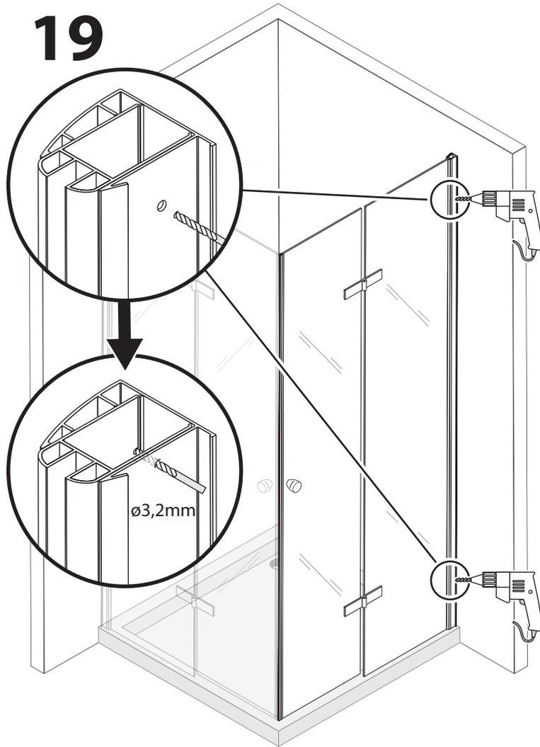
**DE** - Bohren Sie nach dem Ausrichten durch das Wandprofil und Innenprofil, an den vorgegebenen Stellen. Bohren Sie jedoch nicht zu tief, um die Außenseite des Profils nicht zu beschädigen.
