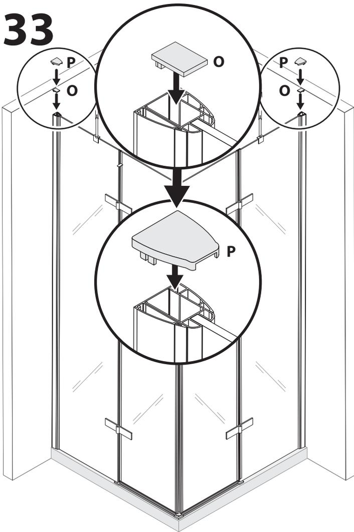
**DE** - Setzen Sie die Abdeckkappe (O+P) oben auf die Profile. Achten Sie darauf, dass die Profile abgedeckt sind.
